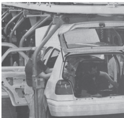
Sistema laboral estacionario, estacionario, trabajo en equipo; puesto en una línea de montaje
